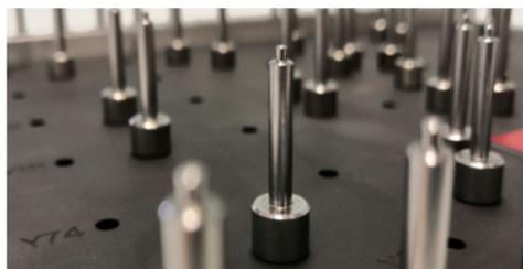
Ziel des festen Positionsstiftes: Trotz des flexiblen Einsatzes der Nutzentrennvorrichtung sind die Baugruppen beim Fräsvorgang sicher fixiert. Hinzu kommt, dass die Andruckwirkung der übrigen magnetischen Stifte ca. 1 kg beträgt. Während die Grundplatte aus brüniertem rostbeständigem Stahl besteht, werden die Stifte aus V2A und die Ablageleisten aus Aluminium hergestellt.
