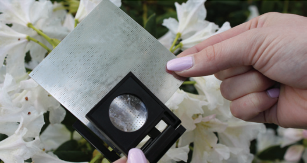
Kalibrierungsschablone für ein Röntgengerät mit über 250.000 Löchern
