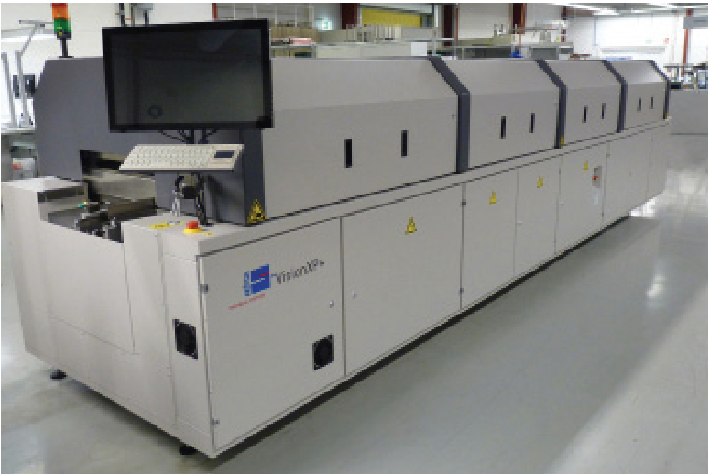
Der neu gelieferte Reflow-Lötofen ist der erste Baustein einer neuen Produktionslinie
