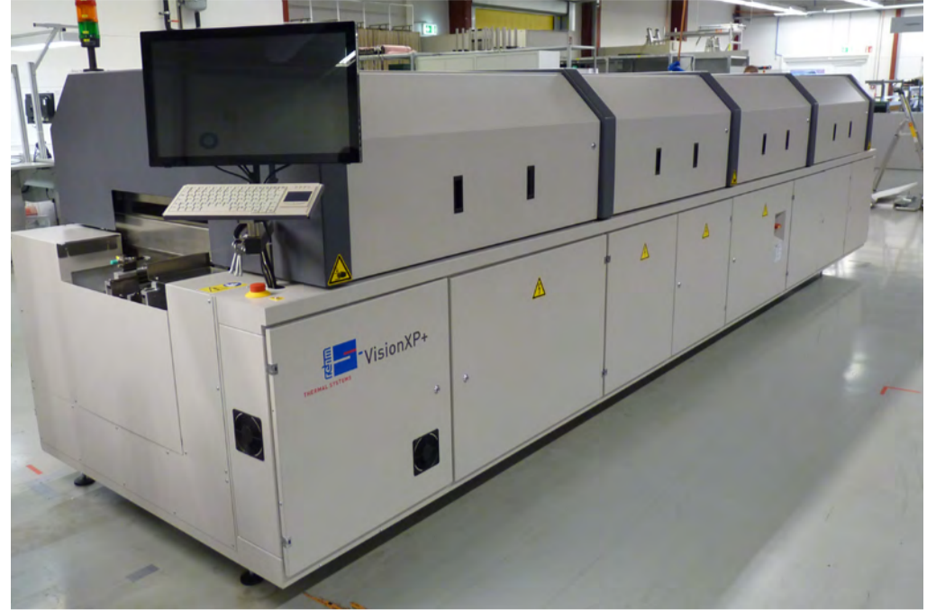
Der neu gelieferte Reflow-Lötoven ist der erste Baustein einer neuen Produktionslinie
