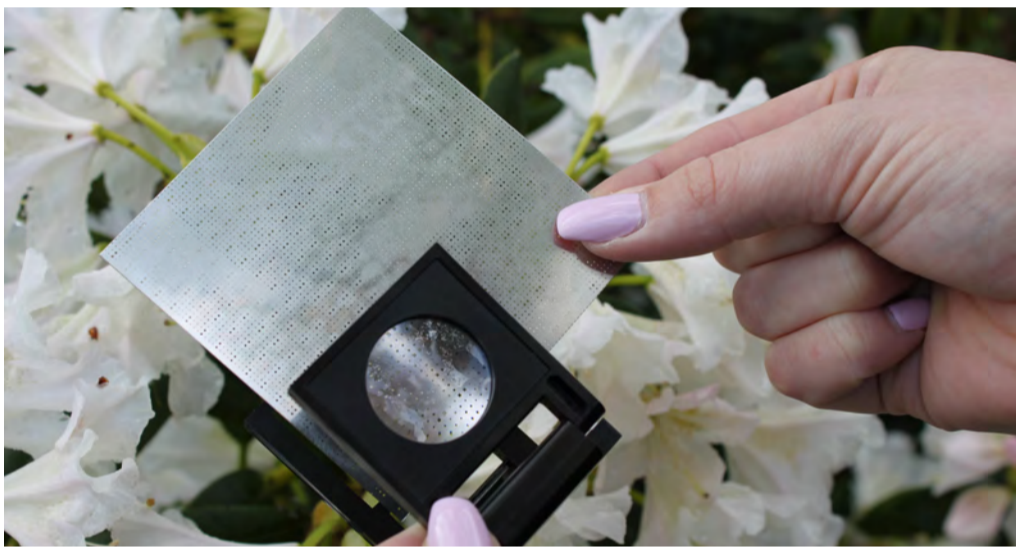
Kalibrierungsschablone für ein Röntgengerät mit über 250.000 Löchern
