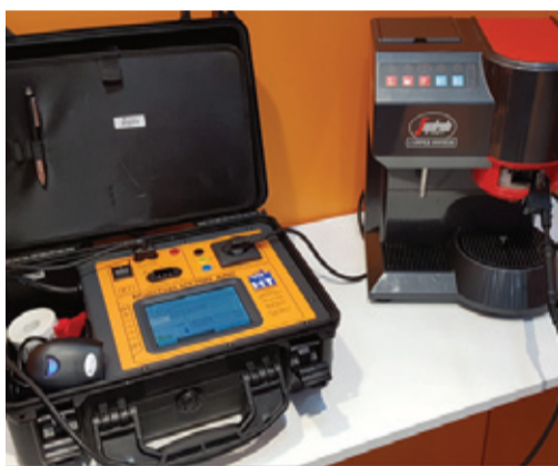
Isolationsprüfung einer Kaffeemaschine mittels HT700
